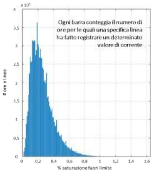
Figura 13 - Distribuzione di saturazione fuori limite per ora e linee contro - affacciate
